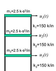
$$\omega_n = \begin{bmatrix} 3.44 \\ 9.66 \\ 13.96 \end{bmatrix} \text{ rad/sec} \quad T_n = \begin{bmatrix} 0.65 \\ 0.45 \\ 0.45 \end{bmatrix} \text{ sec}$$
