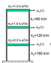
$$\omega_n = \begin{bmatrix} 4.58 \\ 9.83 \\ 14.57 \end{bmatrix} \text{ rad/sec} \quad T_n = \begin{bmatrix} 1.37 \\ 0.639 \\ 0.431 \end{bmatrix} \text{ sec}$$
