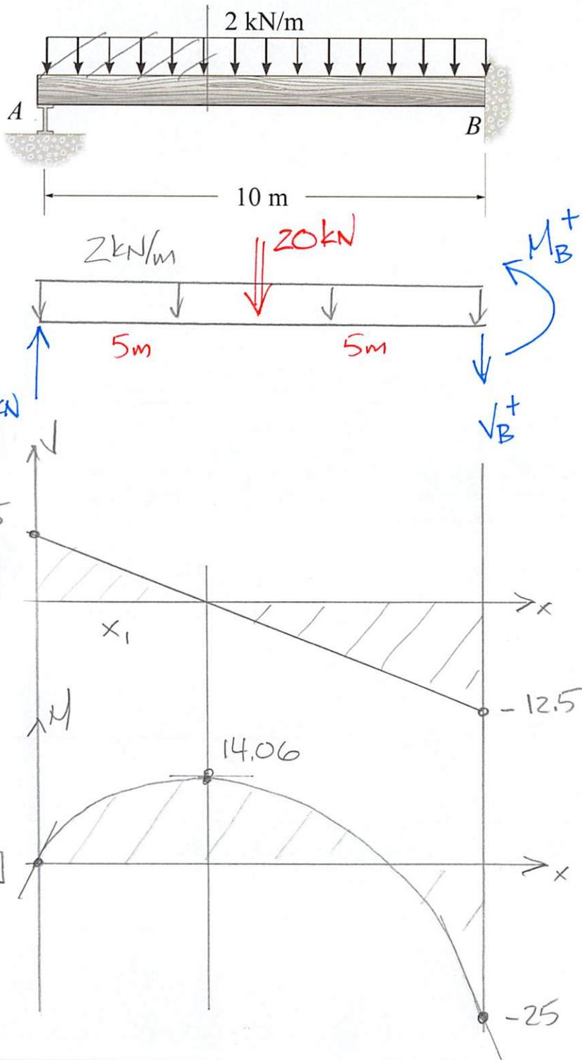
$$\sum M_B = 0 = M_B + 20\text{kN}(5\text{m}) - 7.5\text{kN}(10\text{m})$$
